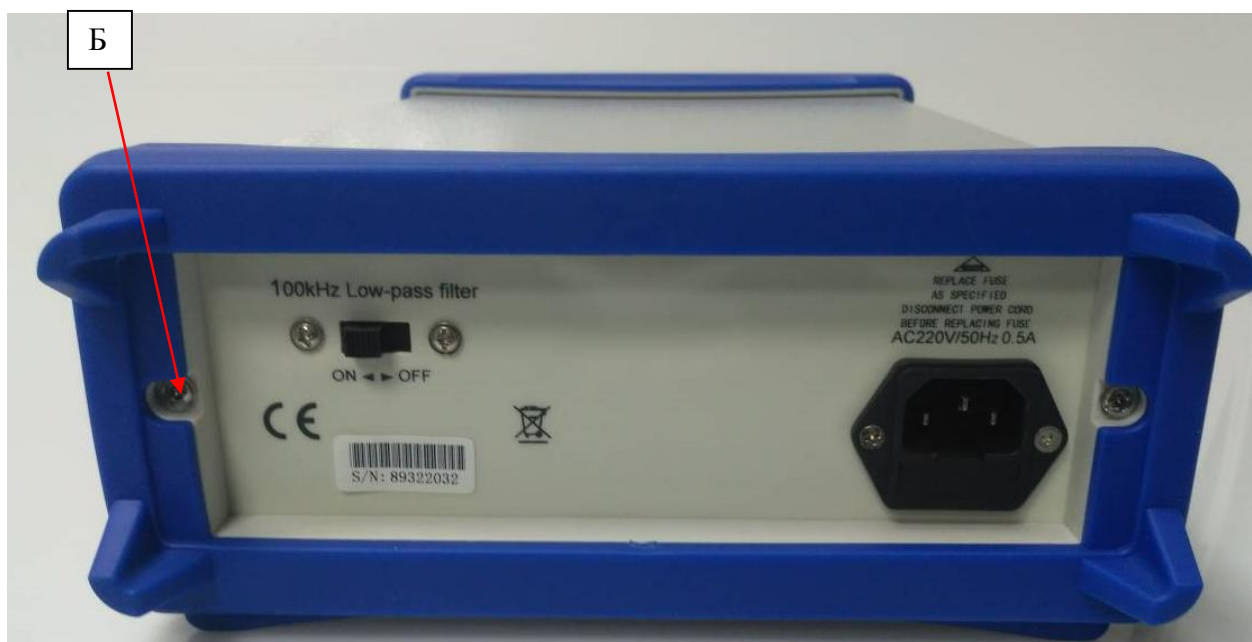
Рисунок 2 - Схема пломбировки от несанкционированного доступа (Б)
